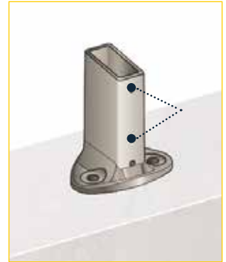
5 - Schroef de verzonken zeskant-schroeven vast.
