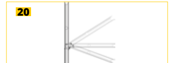
20 Klappbarer Pfosten Kerbe Ø45 mm H: 1010 mm - Alu-Gelenk
