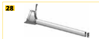
28 25°-Grundplatte mit geklipster Kunststoffsohle und mechanisch verschweißter Strebe speziell für geneigtes selbsttragendes Geländer
