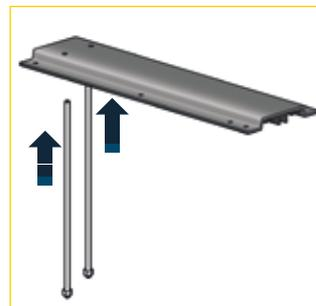
2 - Coloque las varillas roscadas sobre la placa de fijación.
