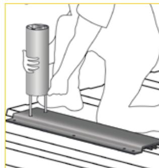
4 - Antes de colocar el aislamiento, inserte los tubos con las varillas roscadas en las 2 piezas circulares previstas para ello.
