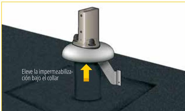
7 - Complete el aislamiento y la impermeabilización. > Modelo sin maniguito: complete la impermeabilización hasta debajo del collar.
